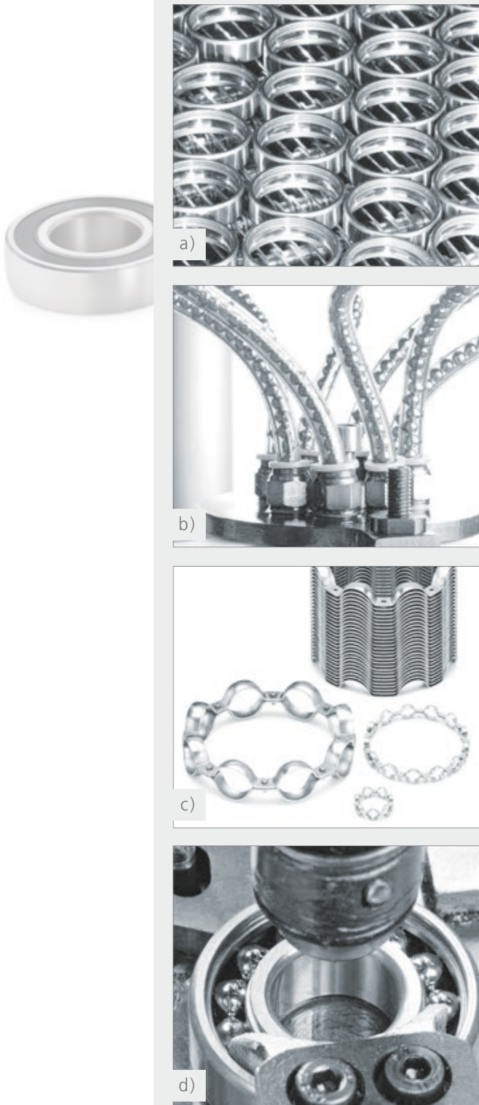
Bild 3: Wälzlagerkomponenten während der Fertigung: a) gehärtete Außenringe, b) automatische Kugelführung, c) genietete Käfige, d) Lagermontage
