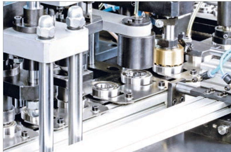
Bild 2: Vollautomatisierte Fertigungsstraße der Lagerproduktion bei LFD.
